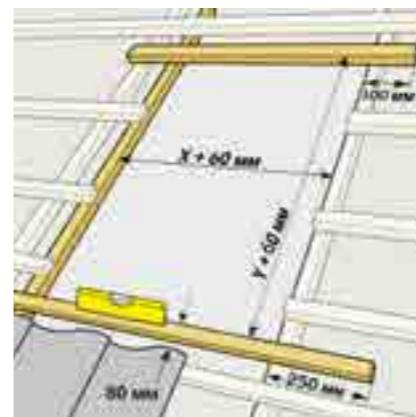
Технологичният отвор, необходим за правилен монтаж на покривния прозорец, трябва да бъде около 60 mm по-широк и 60 mm по-висок (от размерите на покривния прозорец по таблицата).
