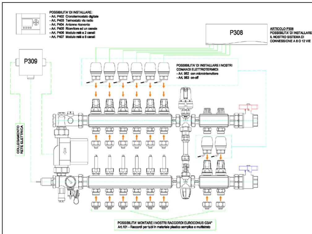
**ESEMPIO DI INSTALLAZIONE SU COLLETTORE PER IMPIANTO A PANNELLI RADIANTI**
