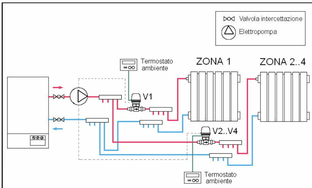
**ESEMPIO DI INSTALLAZIONE SU VALVOLE DI ZONA PER IMPIANTO A RADIATORI**
