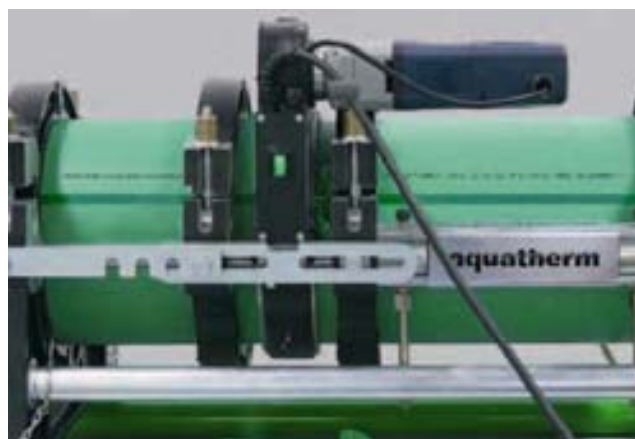
Заваряемите части се затягат, изравняват, фиксират, поставя се фрезата
