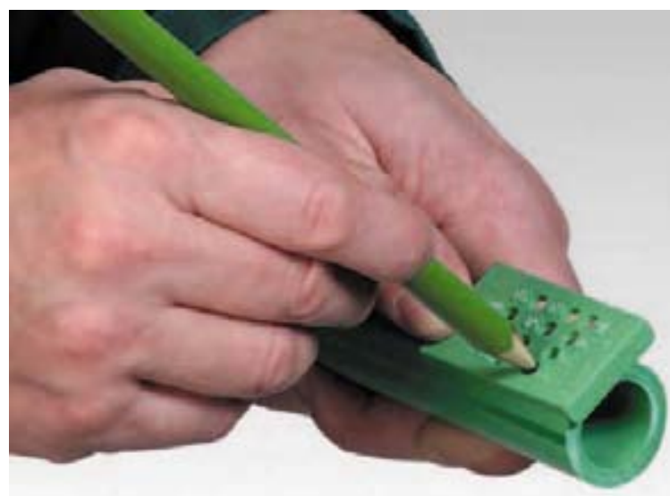
Отбелязване на дълбочината на заваряване
