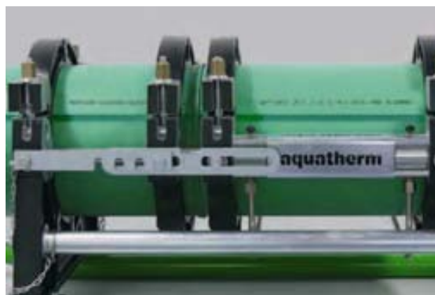
Отделяне на тръбите, изваждане на нагревателния елемент
