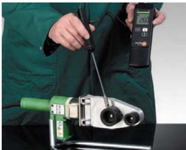
Проверка на температурата с контактен термометър
