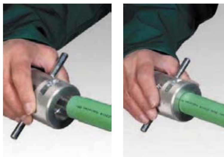
Обелване на алуминиево-пропиленния слой (отпада при fusiotherm® и fusiotherm® тръби със стъклофибър!)
