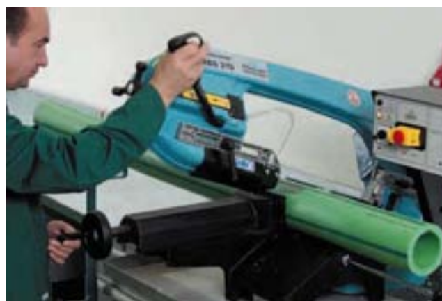
Преди заваряването тръбата трябва се отреже до желаната дължина
