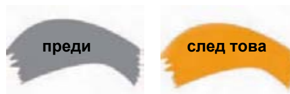
Проверка на температурата с креда:
