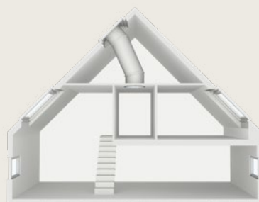
Твърд светлинен тунел за скатен покрив
