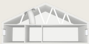
Гъвкав светлинен тунел за скатен покрив
